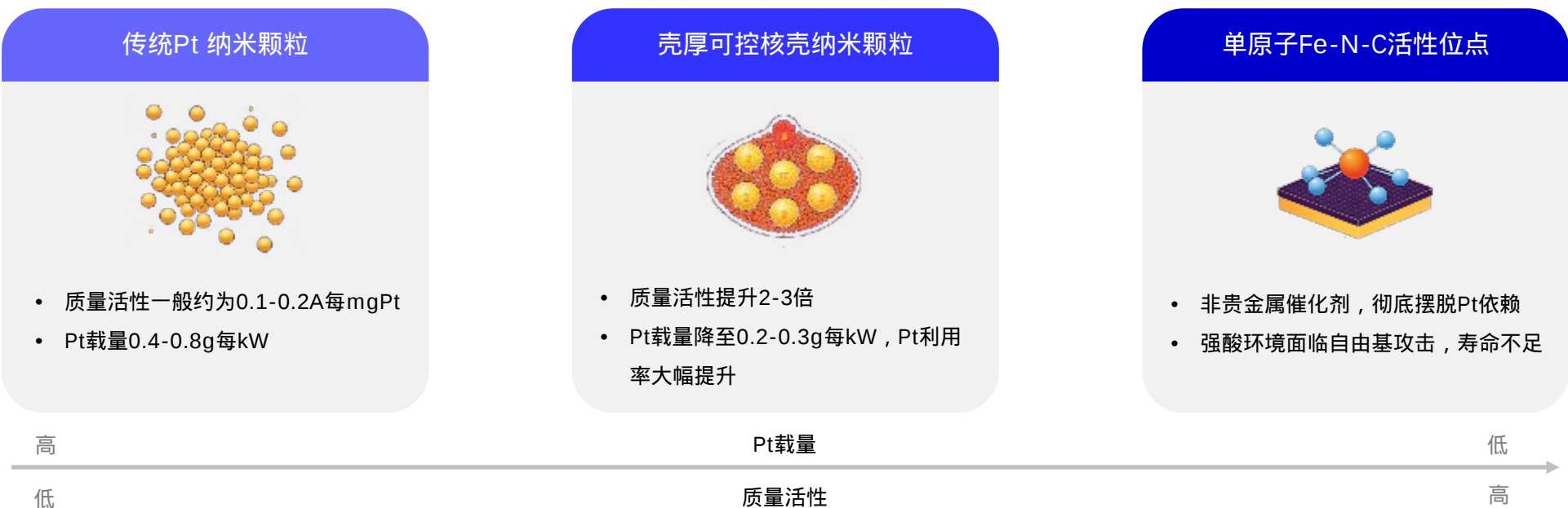
三种前沿催化剂微观形貌及特性对比示意图
